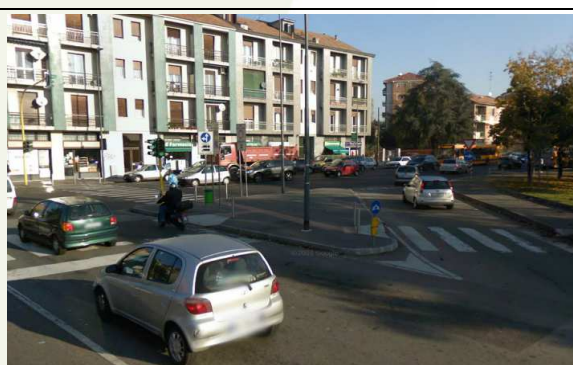
Milano, via Bagarotti. L'allungamento dell'isola è sufficiente per offrire un appoggio al ciclista in attesa
