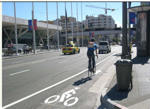
San Francisco. La strada pluricorsia prevede una fascia ciclabile sulla destra. La presenza della scolina è utilizzata come franco rispetto al cordolo del marciapiede e riduce meno la superficie utile di corsia.
