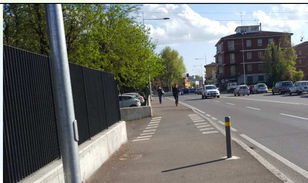
In evidenza la visibilità reciproca praticamente nulla tra ciclista ed automobilista, che costringe il ciclista a rallentare ad ogni immissione e passo carraio (via Ferrarese).
