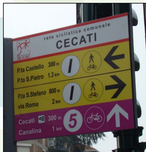
Reggio Emilia: esempio di cartello di incrocio L'indicazione della pista ciclabile può essere omessa e le distanze sostituite con i tempi
