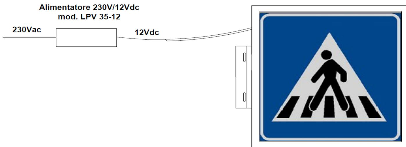
Tutti i componenti elettrici impiegati rispettano la marchiatura CE e rispondono alle Normative CE 61347-2-13, UNI EN 55015, UNI EN 61547 e UNI EN 611000-3-2 oltre che alle Normative in materia di Sicurezza UL 1310 classe II e grado di protezione IP66
