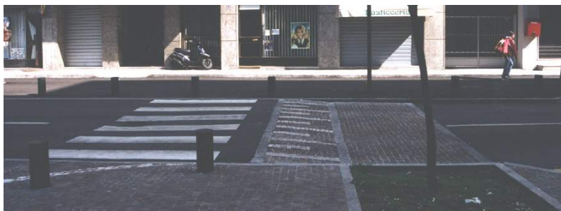
Esempio di sopraelevazione dell'attraversamento pedonale in una strada moderata
