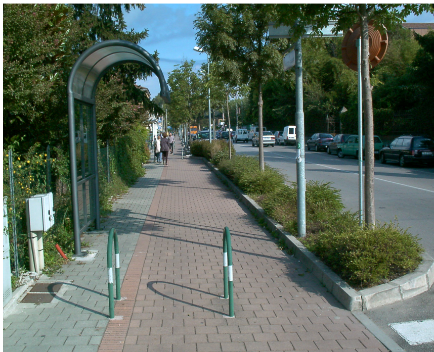
Esempio di pista ciclabile bi direzionale separata da aiuole di verde della carreggiata.
