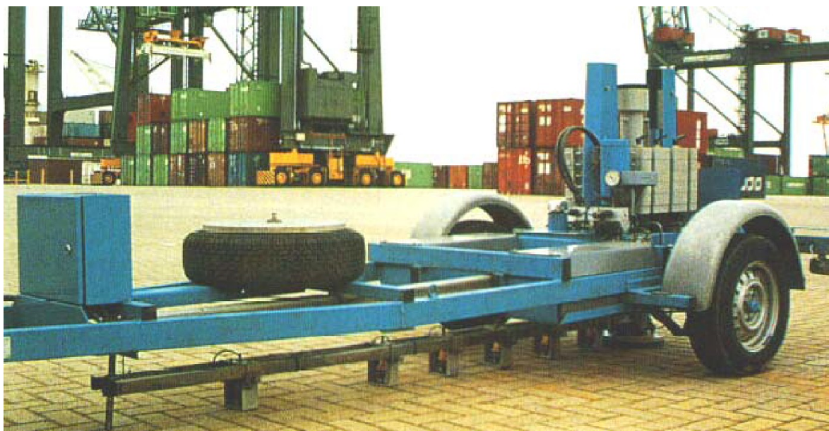
Figura 3: Strumentazione Falling Weight Deflectometer (FWD)
