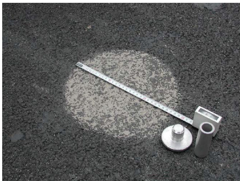
Figura 2: Strumentazione per misurazione altezza media in sabbia
