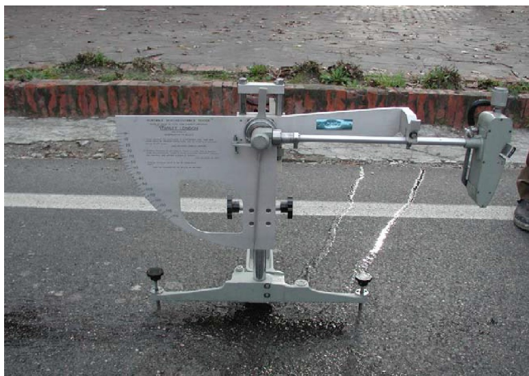
Figura 1: Strumentazione per Skid Tester
