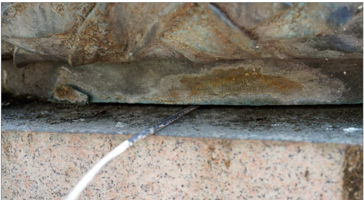
Inserimento della sonda endoscopica all'interno del monumento in bronzo
