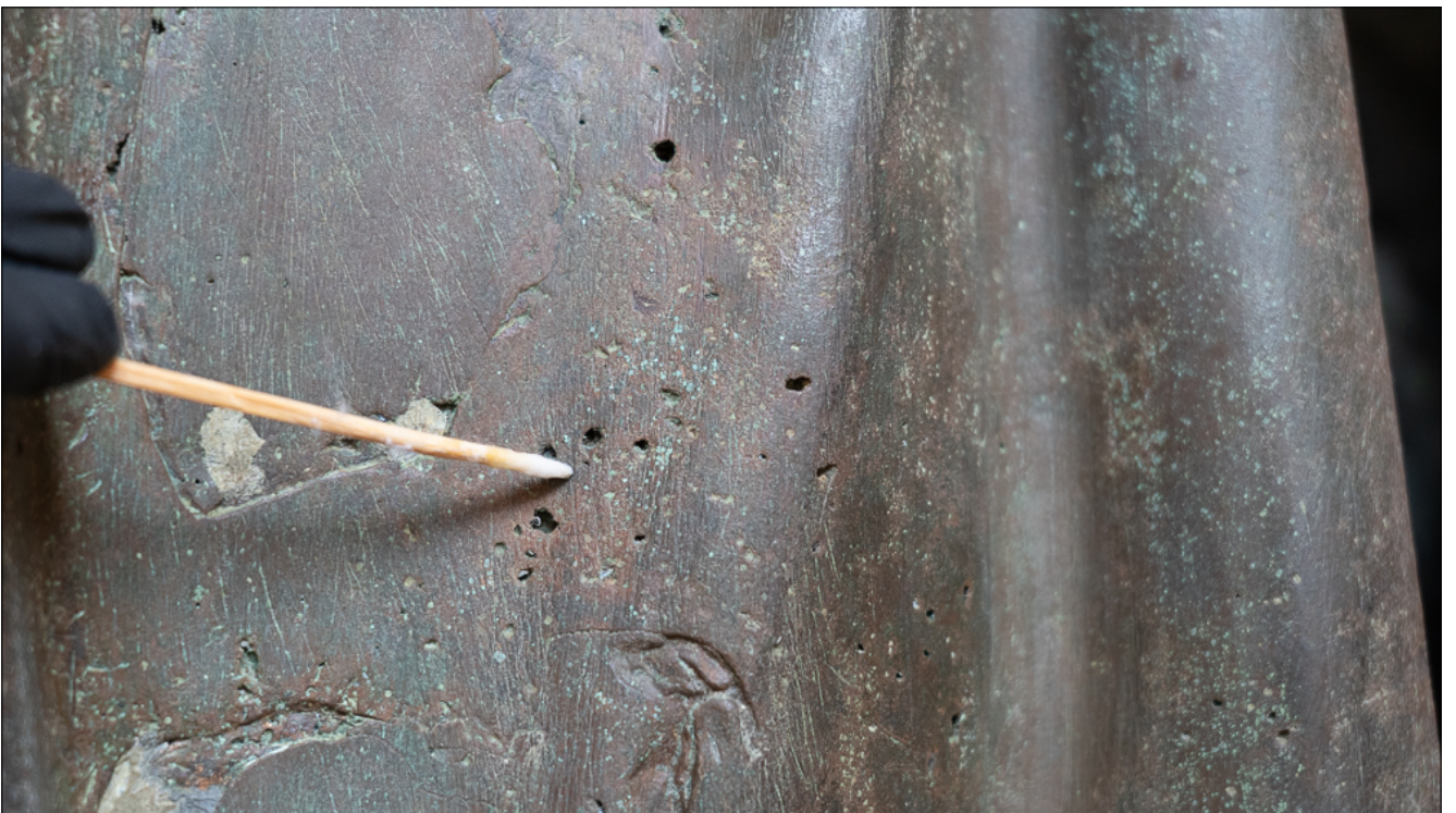
Trattamento B70 a tampone per inibizione delle corrosioni attive- S. Giovanni Battista di Baccio da Montelupo, Museo di Orsanmichele, Firenze
